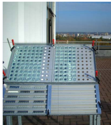
Abb. 2: Freibewitterungsstand mit Zylinderprüfkörpern (oben) und Druckscherprüfkörpern (unten)
