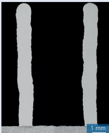
Mikro-Wandstrukturen-Querschnitte aus 28 Lagen mit 0,4 mm Draht- und 1 mm defokussiertem Laserstrahl-Durchmesser.
