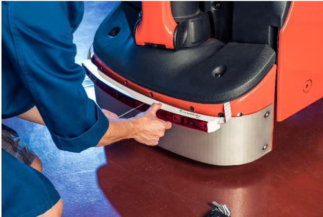
Abb. 3 Spezielle optische Sensoren des Fraunhofer-Anwendungszentrums AZOM soll das Risiko von Transportunfällen mit Flurförderfahrzeugen senken.
