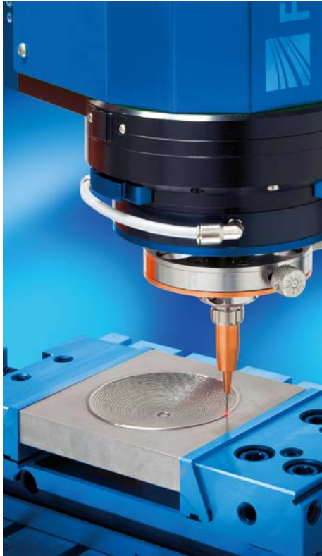
COAXwire-Bearbeitungsoptik zum Auftragschweißen und Generieren © Fraunhofer IWS Dresden / Frank Höhler
