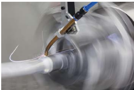
Laserstrahlschweißen von Aluminium-Druckguss-Komponenten © Finow Automotive GmbH / Steffen Herre
